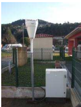
Pluviomètre situé à Saint-Martin-du-Var (Gendarmerie)
