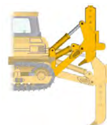
Equipement arrière: dent de ripper ou défonceuse
